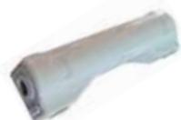
Le Y de dérivation permet, lors d'une installation du câble de colonne montante en goulotte, d'acheminer par tube les éléments de fibres extraits vers un Point de Branchement d'Immeuble. Il permet de gérer deux tubes de 5 mm diamètre.
