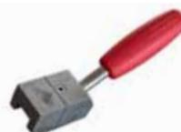
L'outil d'ouverture de câble (VCST) est utilisé lors d'installation de câbles de colonne montante en Immeuble. Il permet de pratiquer une fenêtre longitudinale sur un câble (diamètre entre 8 et 16mm). Cette fenêtre permet d'extraire les modules contenant les fibres optiques.
