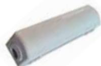
Cet accessoire recouvre les fibres lorsqu'une fenêtre a été réalisée sur un câble de colonne montante. Il assure une protection maximale et une réouverture aisée pour l'extraction des autres fibres. Le diamètre de câble maximal accepté est de 15 mm.
